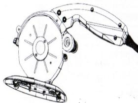
2. Umístěte šestihraný klíč do polohovacího otvoru. S použitím upínacího klíče (2) odšroubujte v protisměru pohybu hodinových ručiček napínací kotouč. Odstraňte kotouč.
